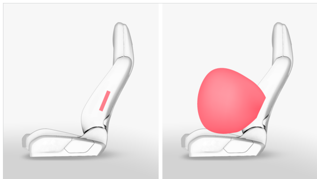
Расположение и область раскрытия боковых подушек безопасности
